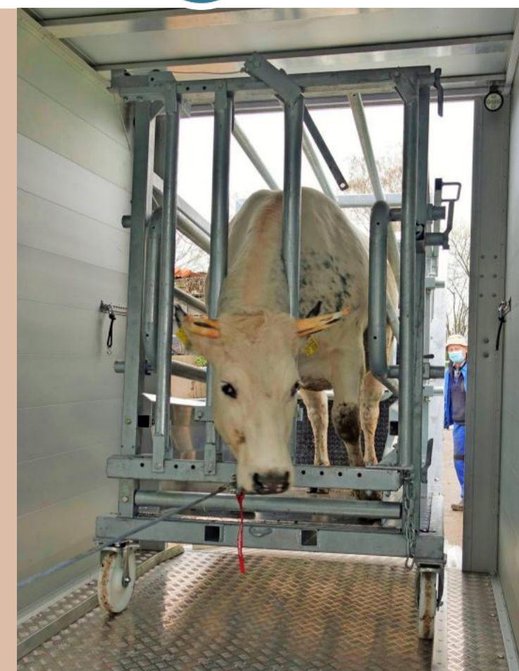
Eine Seilwinde zieht das Fanggitter samt Rind in die mobile Schlachteinheit. Ein Mechanismus fixiert den Kopf des Tieres.
